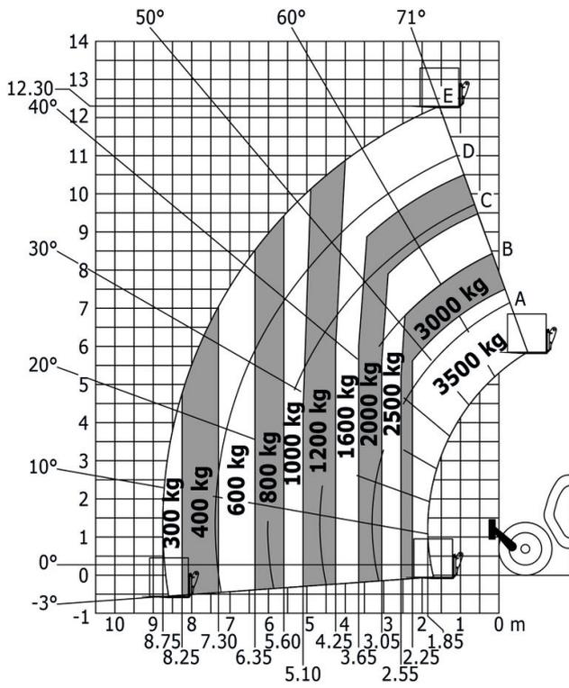
Machine sur pneus avec fourches - avec correcteur de dévers
